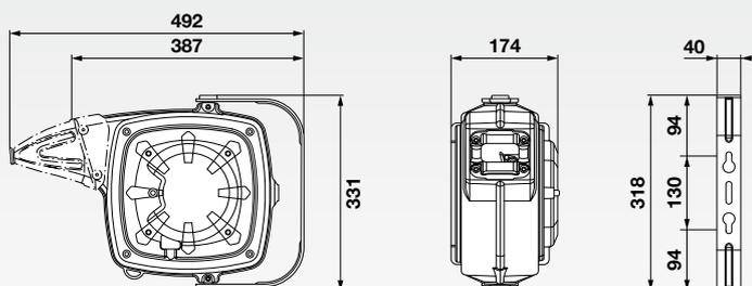
Габаритные размеры катушек с кронштейном (мм)
