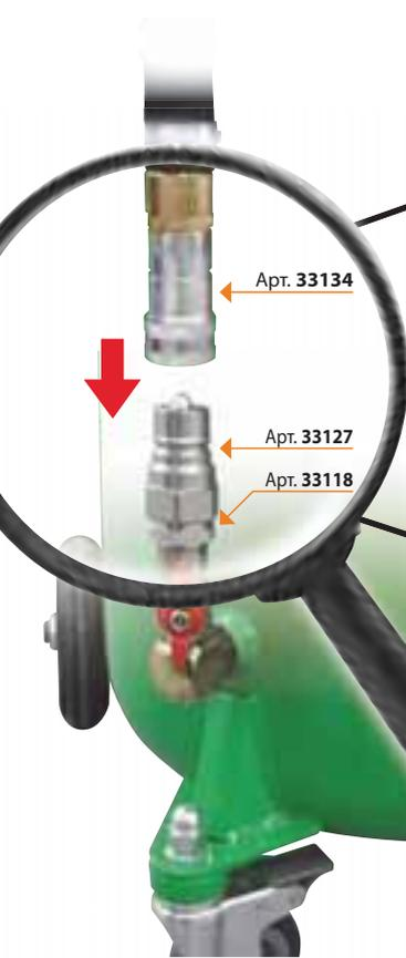
Для подсоединения установок отработавшего масла к описанному выше комплекту слива необходимо монтировать быстродействующее соединение с наружной резьбой. Переходники, используемые для монтажа данного быстродействующего соединения, изменяются в зависимости от типа регенератора (стандартный, над ямой или напольный), и показаны в приведенных здесь примерах (Рис. 1 - 2 - 3).
