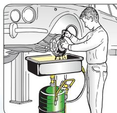
Промывка с использованием щетки-кисти при непрерывном потоке жидкости
