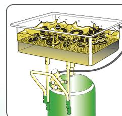
Промывка с погружением, детали находятся в баке
