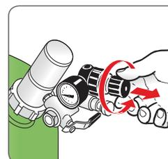
Пневматическая система работает под низким давлением **0,5 бар**, расходуя очень мало воздуха
