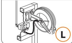
Крюк для блокировки трубки - пистолета подачи
